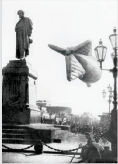
ВО ВРЕМЯ ВОЙНЫ ЗАГРАДИТЕЛЬНЫЕ АЭРОСТАТЫ ШИРОКО ПРИМЕНЯЛИСЬ ДЛЯ ЗАЩИТЫ ГОРОДОВ, ПРОМЫШЛЕННЫХ РАЙОНОВ, ВОЕННО-МОРСКИХ БАЗ И ДРУГИХ ОБЪЕКТОВ ОТ НАПАДЕНИЯ С ВОЗДУХА. НАЛИЧИЕ В СИСТЕМЕ ТВО АЭРОСТАТОВ ЗАГРАЖДЕНИЯ ВЫНУЖДАЛО САМОЛЕТЫ ПРОТИВНИКА ЛЕТАТЬ НА БОЛЬШИХ ВЫСОТАХ И ЗАТРУДНЯЛО ПРИЦЕЛЬНОЕ БОМБОМЕТАНИЕ С ПИКИРОВАНИЯ.
